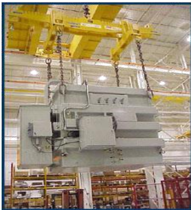
2.1 сурет – Қуаты 5/10 МВА үшфазалы ЖТАӨ трансформаторы
